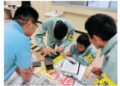
長崎大学での研修 2 (左写真より、浸透探傷試験、磁粉探傷試験、鍍厚・膜厚超音波測)
