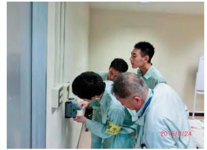
長崎大学での研修 1 (左写真より、中性化ドリル法、電磁誘導法、電磁波レーダー法)
