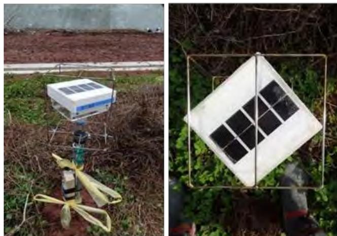
図-8.4.7 避雷ケージ付きセンサ端末の設置状況
