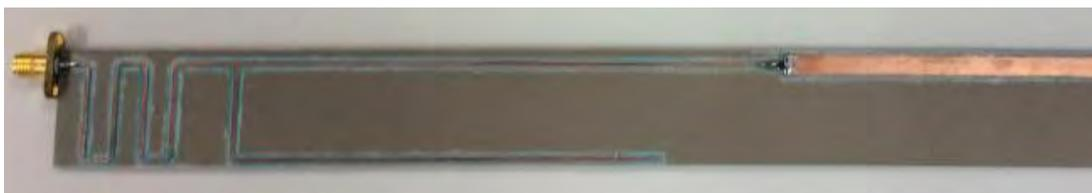
図-8.4.6 提案するレクテナ用回路
