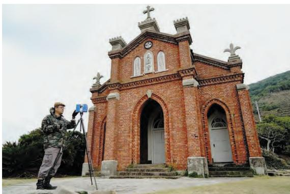
3D レーザースキャナーでの計測
