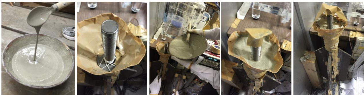
(a) 練り混ぜ (b) 位置セット (c) 打設 (d) 恒温室養生状況 (e) 硬化完了状況
