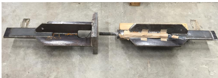
写真2 載荷後(B-2 シリーズ)の試験体状況
