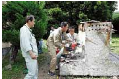
③中性化ドリル法 演習状況
