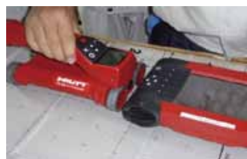
鉄筋探査実習②
