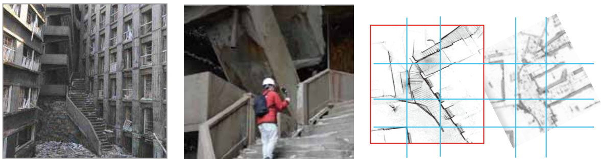
地獄段（左）と計測状況、ZEB1 の平面オルソと実測図面
