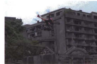
図 2.4.1 DSLR 搭載可能なマルチコプター カメラ下向きタイプとカメラ上向きタイプ
