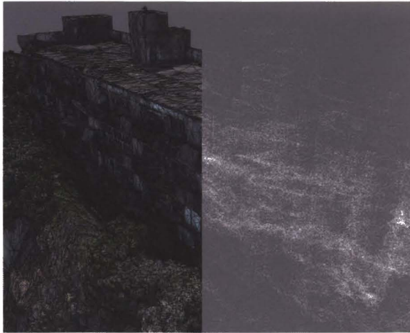
生成したモデルはTINで構成され、点群としても表現可能
