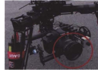
図 2.4.1 DSLR 搭載可能なマルチコプター カメラ下向きタイプとカメラ上向きタイプ
