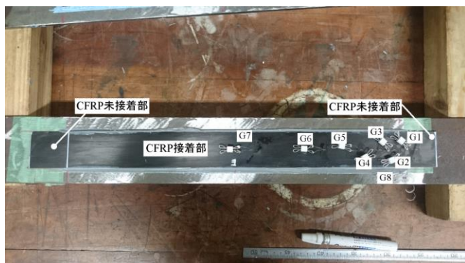
写真1 端部未接着試験体
