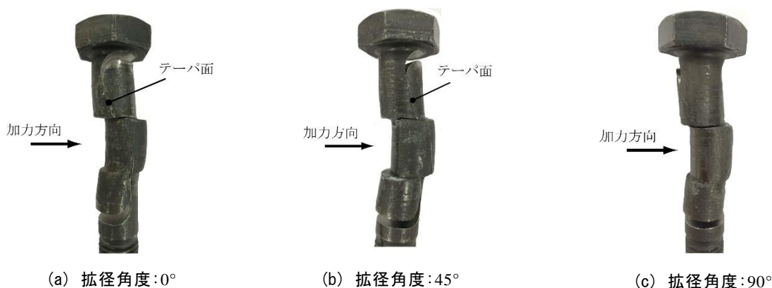
写真2 充填ボルトの終局状態 (シリーズII)
