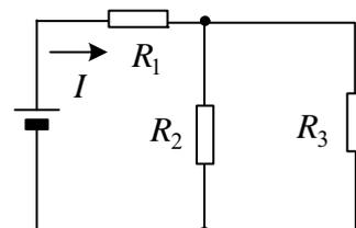
(解) 抵抗の値が等しいので、分流の式より、 $R_2, R_3$  に流れる電流は  $I/2$  である。各抵抗の消費電力は
