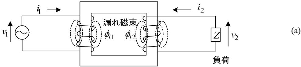
巻線抵抗  $r_1, r_2$  と漏れ磁束を作るインダクタンス (漏れインダクタンス  $l_1, l_2$ ) を変圧器の外に出す。
