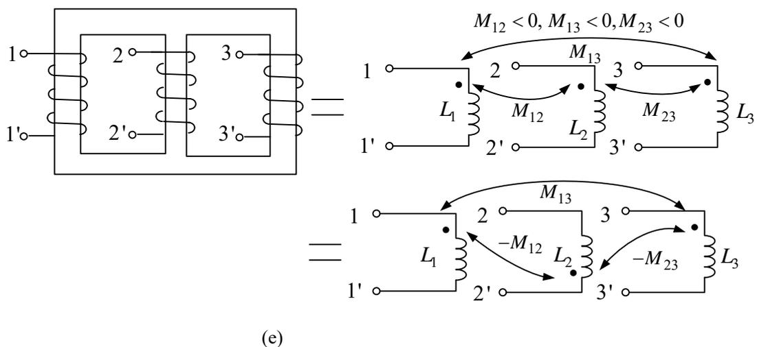
2つのコイルで、●印の所からコイルに電流が流れ込んだとき鉄心にできる磁界が強めあうなら、その相互インダクタンスは正となる。(a)~(c)の場合は図のように●印を選んで相互インダクタンスは全て正にできる。(d)の場合は、 $\theta = \pi$ のとき相互インダクタンスは $-M$ となる。(e)の場合は、どのように●印を選んでも相互インダクタンスを全て正にすることはできない。
