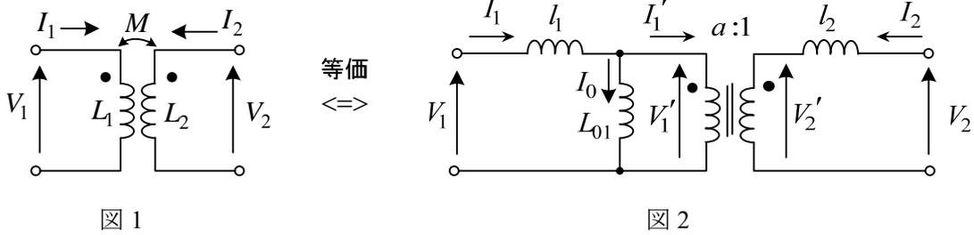
(解) 図のように電圧、電流を定義する。
