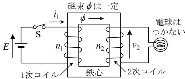
図 10-1 変成器 (直流電源接続)
