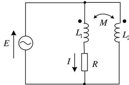
問題 4 図の変成器で時刻  $t$  の電流が  $i_1(t), i_2(t)$  のとき, 変成器に蓄えられているエネルギー  $W$  を求めよ。
