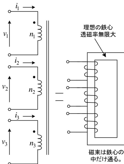
図の理想変成器は、同じ鉄心に3個のコイル (巻数  $n_1, n_2, n_3$ ) が巻かれており、巻数だけで電圧と電流の関係が決まる。
