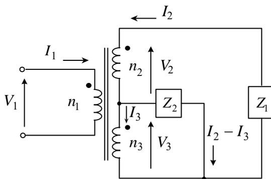
(解) 図のように、フェーザ  $V_1, I_1, V_2, I_2, V_3, I_3$  を定義する。
