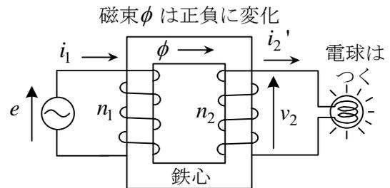
図 10-2 変成器 (交流電源接続)
