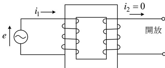
回路では、一次コイルの**自己インダクタンス**  $L_1$ 、二次コイルの**自己インダクタンス**  $L_2$ 、**相互インダクタンス**  $M$ （●印付き）を用いて変成器を表現する。この中に、上記1, 2, 4の情報が含まれる。後で述べるが、理想変成器の場合には、密結合、巻線抵抗 0、励磁電流 0 であり、単に●印と巻数比だけで表現される。理想変成器には、インダクタンスの成分は何も残らない。
