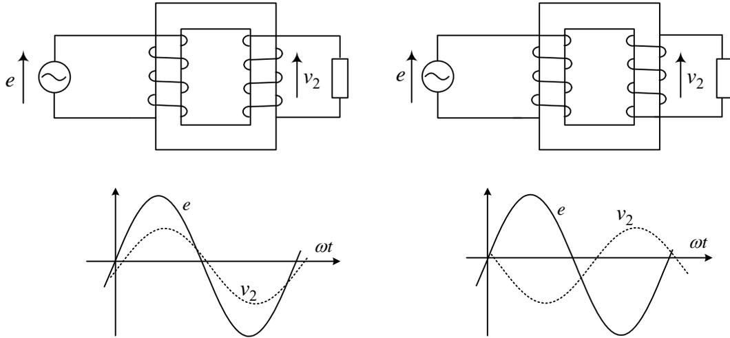
2. 鉄心の外に少し漏れる磁束線（磁束）がある。回路では**漏れ磁束** (leakage flux)として式を作る。電圧の比と巻数の比が完全には一致しなくなる原因の1つとなる。漏れ磁束がない場合を**密結合**といい、後で述べるように、 $L_1 L_2 = M^2$  が成立する。磁束の大部分は空気より鉄心の中を通る。
