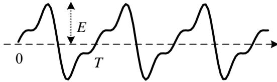
問題 2. 図の回路に、基本波周波数 60Hz のひずみ波電圧  $e = 100 \sin \omega t + 20 \sin 3\omega t$  [V] を加えた。次のものを求めよ。
