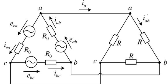
(解) 図のように(a)基本波成分, (b)第 3 調波成分に分けて, 重ね合わせの理を利用する。
