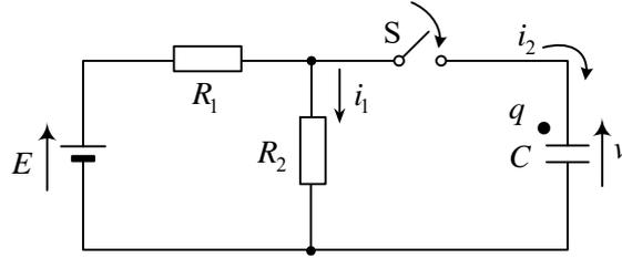
(解)  $S$  を閉じた後、 $i_1, i_2, v, q$  を図のように定義する。成立する式は、
