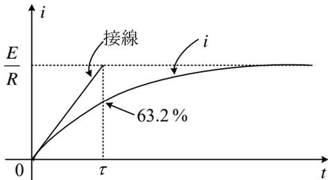
図 15-2 RL 回路の過渡応答
