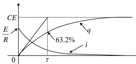
図 15-4 RC 直列回路の過渡応答
