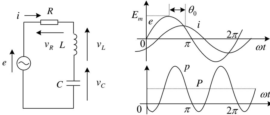
図 5-6 RLC 回路と電流，瞬時電力波形（電流が遅れる場合）
