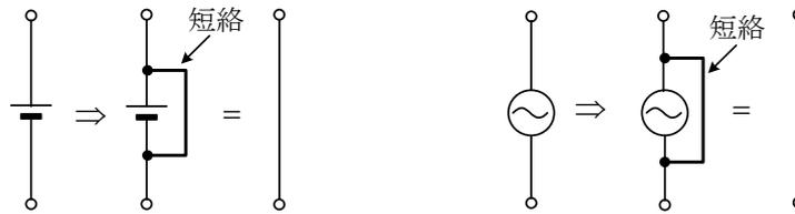
電圧=0は短絡することで達成される。開放しても電圧は発生する。電池には、開放しても1.5Vが出ている。もちろん、図のように実際に短絡してはいけない。
