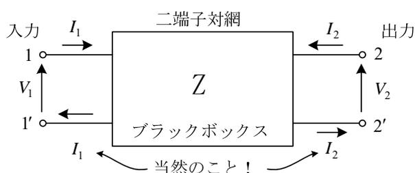
$$\begin{bmatrix} V_1 \\ V_2 \end{bmatrix} = \begin{bmatrix} z_{11} & z_{12} \\ z_{21} & z_{22} \end{bmatrix} \begin{bmatrix} I_1 \\ I_2 \end{bmatrix}$$
