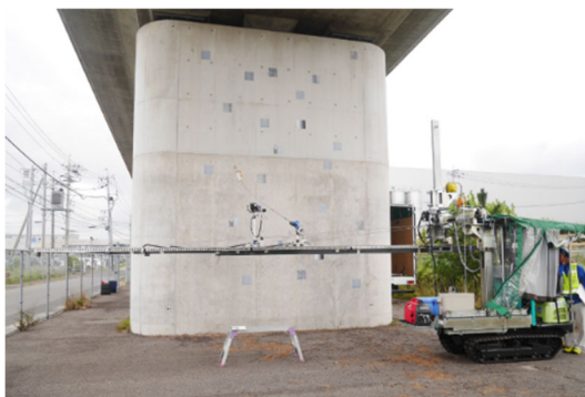
[Ⅱ] 橋梁点検支援ロボット『見る・診る』 撮影状況
