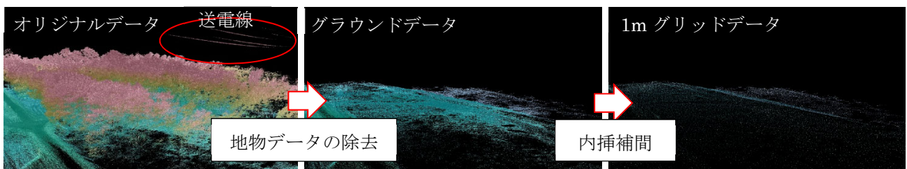
図 2.4.9 取得データのフィルタリング処理
