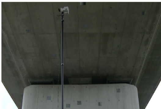
[Ⅰ] 橋梁点検ロボットカメラ 撮影状況
