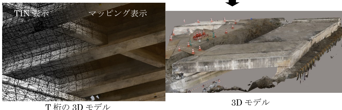
図 5.4.4 SfM 解析による 3D モデル
