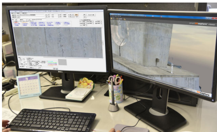
図4.4.3 「ひびわれ位置・幅判読図化システム」による損傷図作成状況
