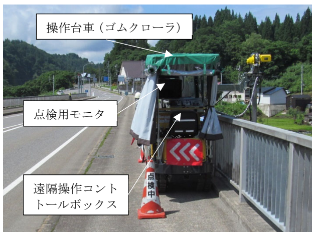
図 6.3.4 橋上の台車設置状況
