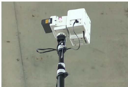
[Ⅰ] 橋梁点検ロボットカメラ 撮影状況
