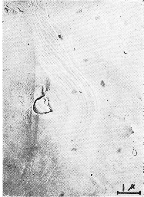
第9図 seagull 模様 (第8図) の部分の電子顕微鏡写真。hill の中心に核があるが、これが拡散して層を形成するように見える。
