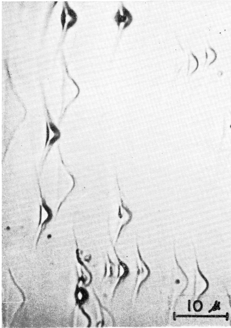
第8図 1050°C に charge を加熱し乍ら下地結晶を極く短時間空気にさらして、直ちに急冷したものの側面を示す。平坦な側面上に seagull 模様が見られる。左方が針状結晶の成長終端である。
