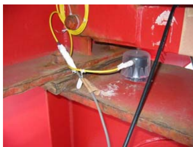
図-3.11 加速度計設置状況
