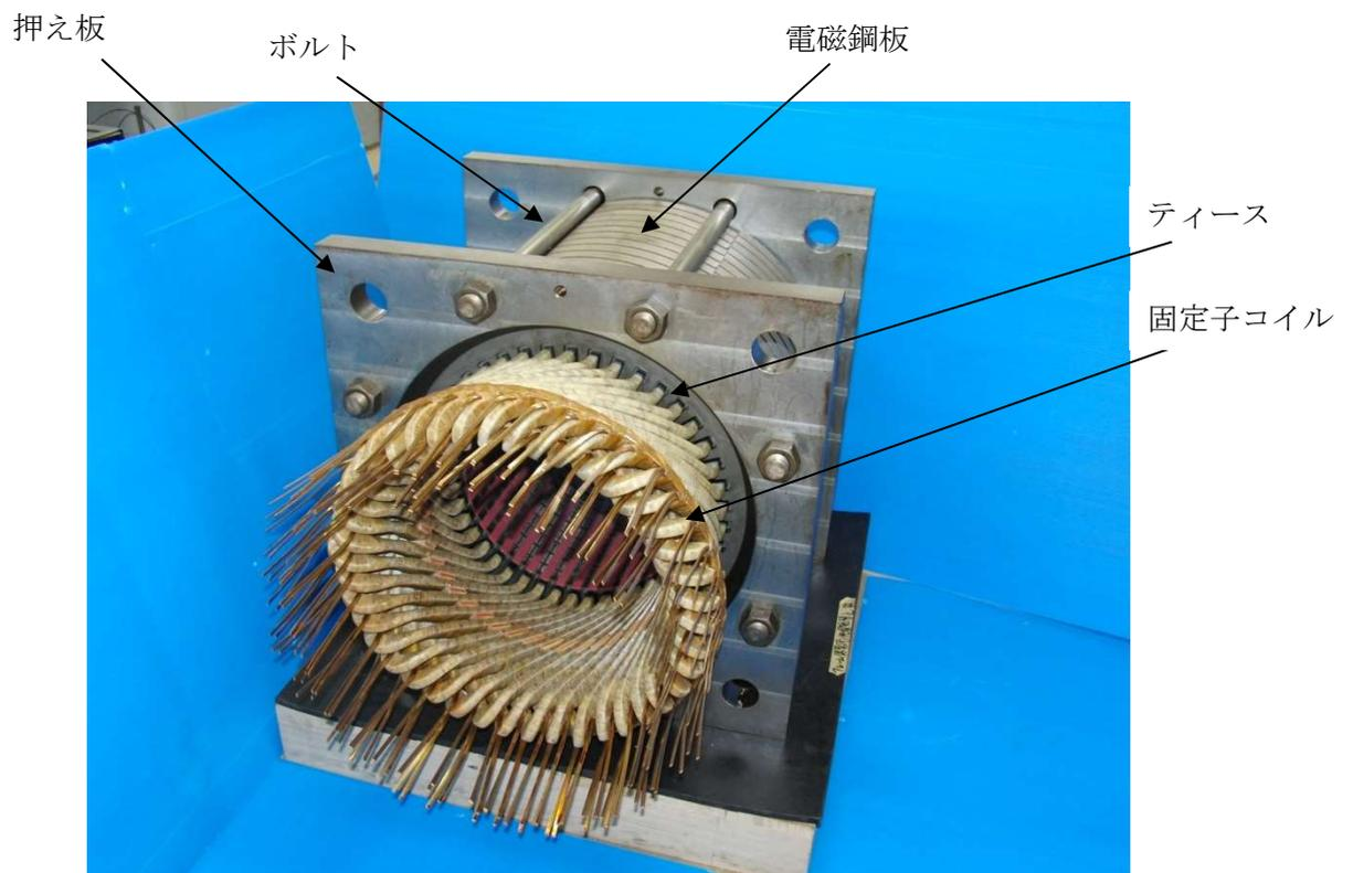
図 2.2 解析対象の電動機固定子
