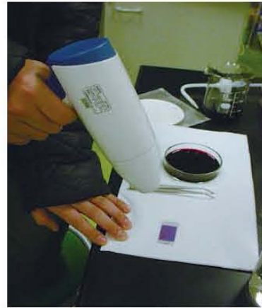
図8 色素が吸着した電極をドライヤーで乾燥している様子
