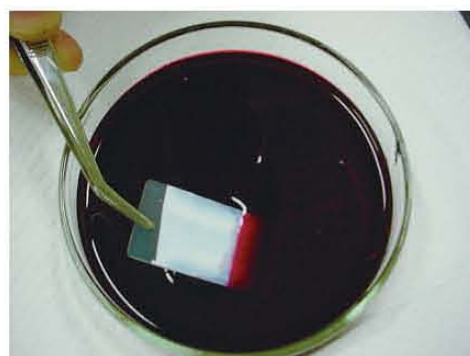
図6 ハイビスカスの花の色素抽出液に酸化チタン固定化電極を浸している様子
