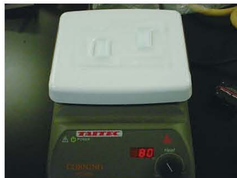
図4 ホットプレート上で乾燥している様子
