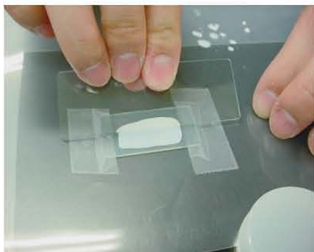
図3 ペーストをスライドガラスで引き延ばしている様子
