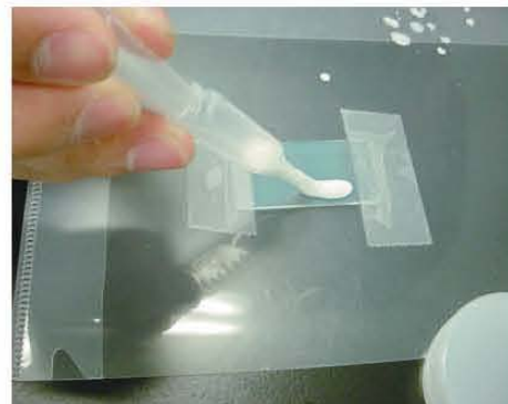
図2 酸化チタンペーストをガラスに塗布している様子
