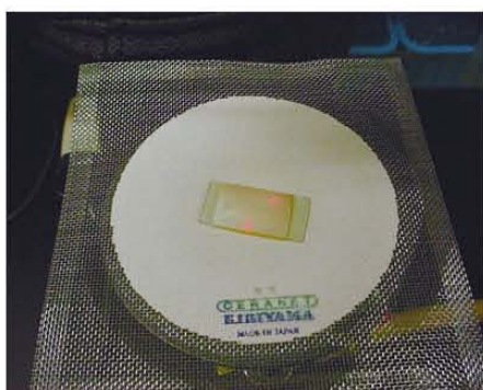
図5 ガスバーナーで加熱して酸化チタンを固定化している様子
