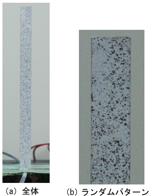
写真 3.2.5 アルミ試験体
