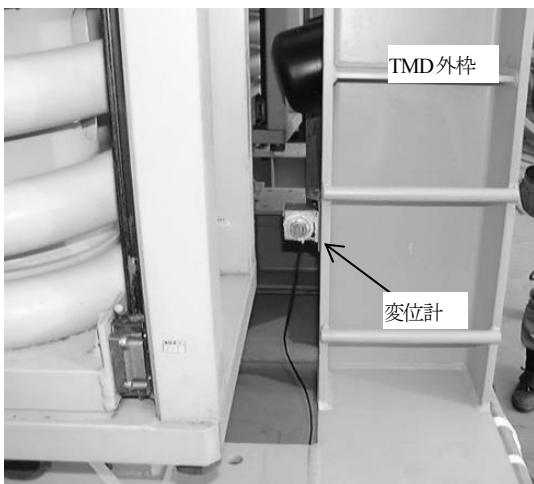
写真-3 塔頂TMD-E3 重錘変位計設置状況
