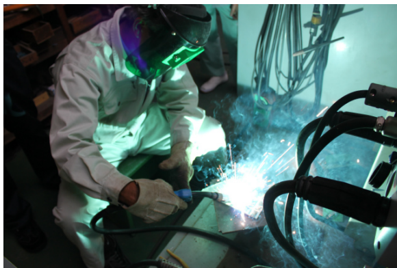
写真 9. レターケース溶接作業
